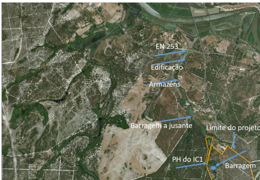
Figura 6.1 – Identificação dos elementos expostos (edificações fixas) a jusante da barragem
